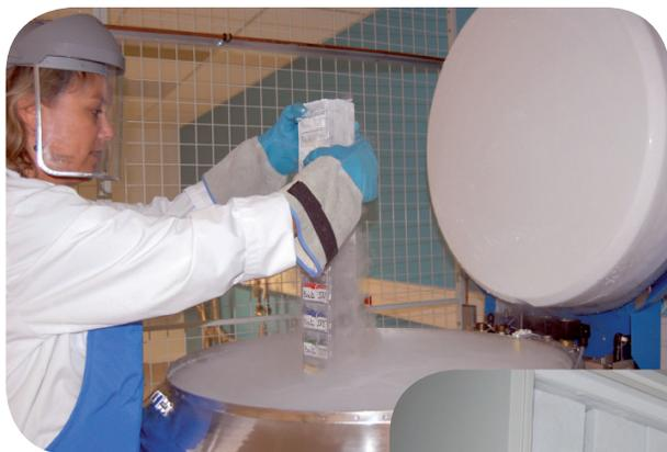
Les échantillons de cellules sont rangés dans des boîtes, elles-mêmes stockées dans des colonnes métalliques adaptées aux cuves d'azote liquide.
